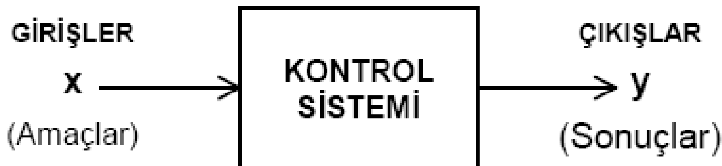
Şekil 1-1 Bir Otomatik Kontrol Sisteminin Blok Diyagramı
