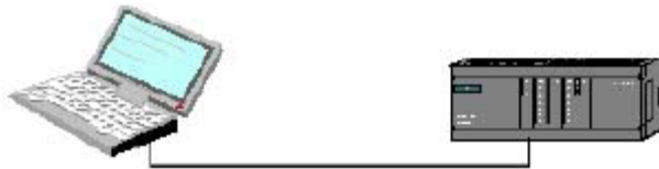
Bilgisayar ve PLC RS 485 bağlantısı
